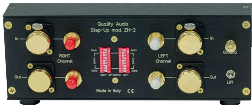
Il pannello posteriore offre ingressi ed uscite sbilanciati e bilanciati (qui coperti). Ci sono anche dip switch per settare i principali parametri.
