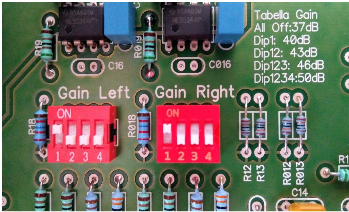
Per il **Gain** sono presenti due Banchi da 4 Dip, uno relativo al canale sinistro **Gain Left** e uno al canale destro **Gain Right**.
