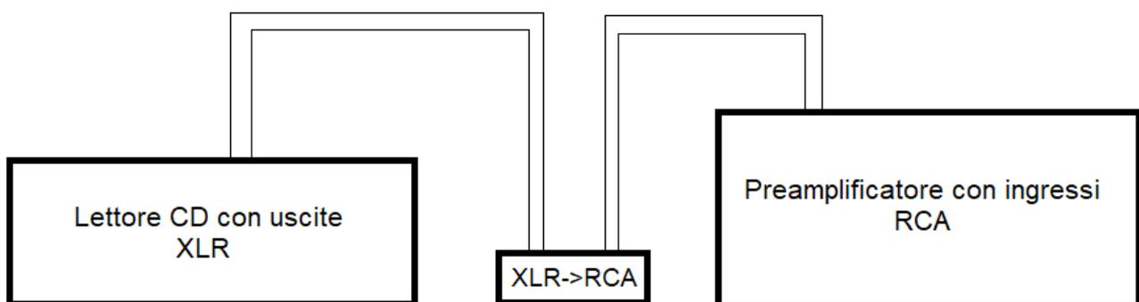
La versione XLR-RCA è invece indicata per collegare una sorgente XLR (es. CD o DAC) ad un Preamplificatore dotato solo di ingressi RCA.
