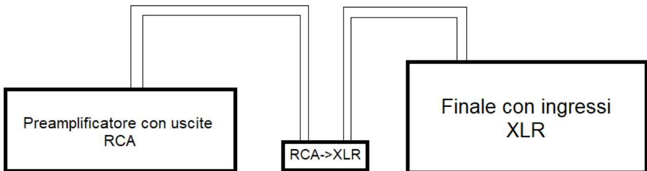
La versione RCA-XLR è particolarmente indicata per collegare un Preamplificatore con uscite RCA ad un Finale dotato di ingressi XLR, anche molto distante, poiché i cavi XLR non captano disturbi.
